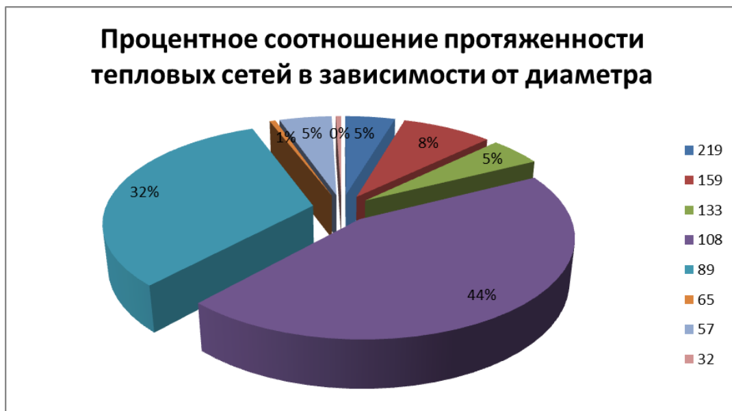
Рисунок 1. Распределение протяженности тепловых сетей по диаметру
